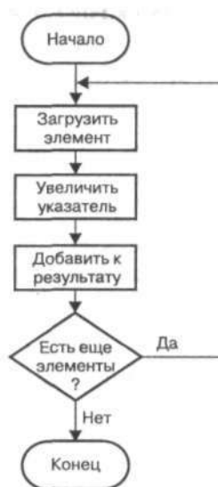
Рис. 7.1. Блок-схема алгоритма суммирования массива
