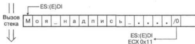
Рис. 6.3. Состояние регистров ES:(E)DI перед вызовом strlen и после ее выполнения
