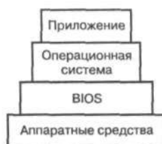
Рис. 8.9. Пирамида доступа к аппаратным средствам компьютера
