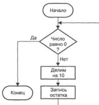
Рис. 7.2. Блок-схема алгоритма преобразования числа в строку
